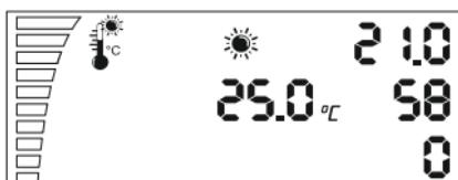
Se premete una sola volta sul tasto "In basso" appare la regolazione della temperatura. Questa regolazione apparirà sul display per 10 secondi e poi il display ritornerà al suo stato iniziale.
