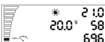
Voorbeeld: 10%rh bij 60% vochtigheid, de ventilator wordt ingeschakeld bij 60% vochtigheid en +10rh, bij 70%rh wordt maximale snelheid bereikt.
