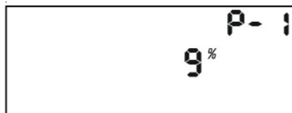
Pode configurar a velocidade que deve corresponder a 1% da velocidade mínima. Carregue no botão para alterar os valores da tela ao girar o botão. Guarde o novo valor carregando no botão. Gire no sentido horário para ir às próximas configurações. Repita para todas as demais configurações.
