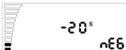
A pressão negativa diminui a velocidade do ventilador inspirador. Exemplo: com 20% o ventilador inspirador funciona 20% mais devagar do que o ventilador aspirador.
