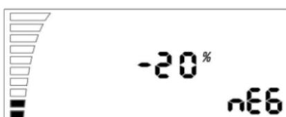
De negatieve druk daalt de snelheid van de inlaat ventilator. Voorbeeld: bij -20% loopt de inlaat ventilator 20% langzamer dan de uitlaat ventilator.
