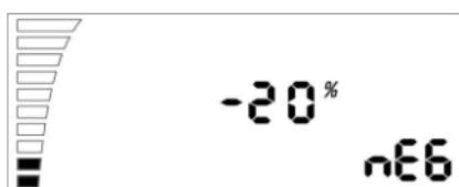
A -0% hanno la stessa velocità. Cambiate il valore con il tasto SET/SAVE. Procedete alla prossima regolazione del sensore di luce.
