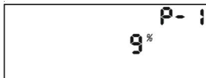
Nu kunt u de snelheid aanpassen, die moet overeenkomen met 1% van de min. snelheid. Druk op de knop om de displaywaarde te wijzigen door de knop te draaien. Sla de nieuwe waarde op door op de knop te drukken. Draai in de klokrichting en ga naar de volgende instellingen. Herhaal dit voor alle volgende instellingen.
