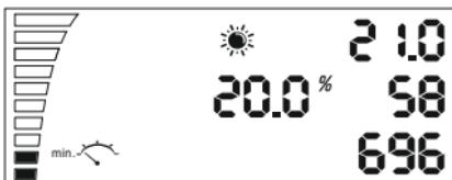
Minimaldrehzahleinstellung Tag. Hier können Sie Minimalgeschwindigkeit des Ventilators einstellen die nie unterschritten werden darf.
