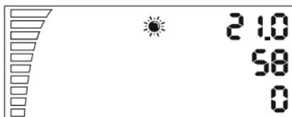
Als nächstes initialisiert der Sensor, im Falle das die LCD Anzeige in diesem Zustand verweilt, ist ein Fehler mit dem Sensor oder deren Kommunikation. Sie müssen das Gerät zur Reparatur zurück senden. Allenfalls erscheint nach ein paar Sekunden die Messwerte, Ventilatorgeschwindigkeit und TAG/NACHT anzeigen.
