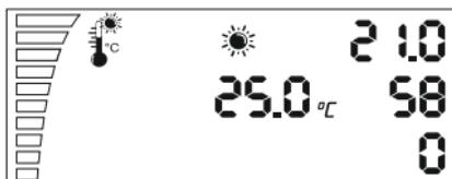
Jestliže stlačíte jednou Down, se objeví nastavení na denní teplotu. Toto nastavení se ukáže na obrazovce asi za 10 vteřin a potom se vrátí do svého původního stavu na obrazovce.
