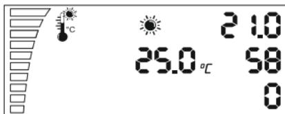
Wenn sie einmal nach AB drücken erhalten Sie die Temperatur Tag Einstellung, Diese Einstellung wird für ca. 10Sekunden angezeigt, danach geht es automatisch auf die Anfangsposition zurück. Die Hintergrundbeleuchtung stellt ab.
