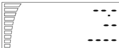
Luego empieza la inicialización del sensor y en el caso de que se mantenga la pantalla de esta manera, entonces hay un problema en el sensor o en su conexión. Debe devolver el ventilador por reparación.
