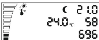
Тази последна настройка служи за превключване между дневен и нощен режим. Ако светлинният сензор достигне ниво за превключване, започва обратно броене в зависимост от секундите, които сте въвели.
