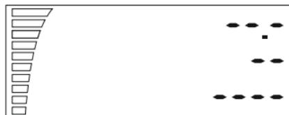
Ensuite commence l'initialisation du capteur et si l'écran garde tous les indicateurs affichés dessus, cela signifie qu'il y a un problème avec le capteur ou avec son raccordement. Le ventilateur doit être réparé.
