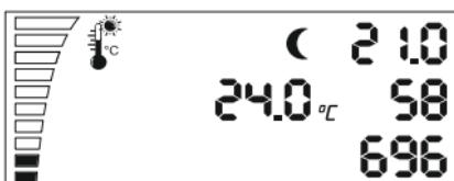
Αφού περάσει η αντίστροφη μέτρηση αυτή, ο ελεγκτής θα κάνει εναλλαγή μόνος του από λειτουργία ημέρας ή αντίστροφα χωρίς να διακόπτεται ο αισθητήρας φωτισμού.
