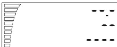
Potom začne inicializace čidla i v případě, že obrazovka zůstane v takovém stavu, to znamená, že je problém se snímačem nebo s jeho spojením. To je důvod, aby jste dali ventilátor na opravu.
