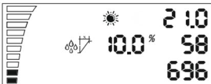
Nastavení na hystereze na vlhkost v průběhu dne tak, jak je popsána výše hystereze teploty. Příklad: 10% rh při 60% vlhkosti, ventilátor začíná pracovat na 60% vlhkosti i + 10% rh, a při 70% rh dosahuje maximální rychlosť.
