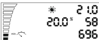
Ajuste de velocidad mínima durante el día. En la parte inferior izquierda puede verse el ajuste corriente de velocidad.
