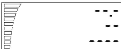
Derefter begynder sensorens initialisering. Hvis skærmen forbliver i denne tilstand, betyder det at der er et problem med sensoren eller dennes tilslutning. Du skal returnere ventilatoren for reparation.
