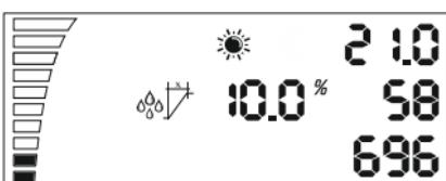
Exemple : 10 % rh et 60 % d'humidité, le ventilateur se met à fonctionner lorsqu'il y a 60 % d'humidité et +10% rh et lorsqu'il y a 70 % rh il atteint la vitesse maximale.
