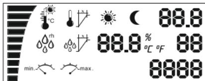
Verbinden Sie das Anschlusskabel mit einer konventionellen Haushaltssteckdose. Die Betriebs LED blinkt und der Ventilator beginnt zu initialisieren. Diesen Vorgang kann einige Sekunden dauern. Zuerst sehen Sie alle Segmente auf der LCD Anzeige und die Hintergrundbeleuchtung scheint.
