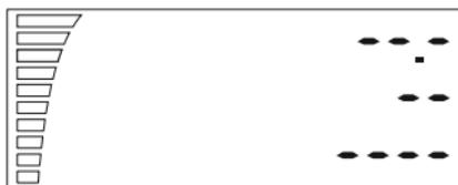
След това започва инициализирането на сензора и в случай, че екранът остава по този начин, значи има проблем със сензора или с неговото свързване. Трябва да върнете вентилаторът за ремонт. В противен случай след няколко секунди ще видите измерената стойност, графата за скорост и фаза ден/нощ.
