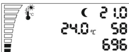
Toto poslední nastavení se využívá na přepnutí mezi denním a nočním režimem. V případě, že světelný senzor dosáhne hladiny spínání, začíná odpočítávání podle vteřin, které jste zadali.
