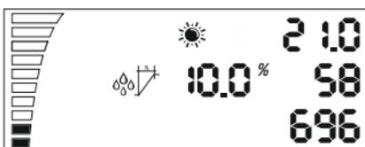
El ajuste de histéresis de humedad durante el día es igual a la antes descrita histéresis de temperatura. Ejemplo: 10% rh en una humedad de 60%, el ventilador empieza a funcionar en humedad de 60% y + 10% rh y en caso de 70% rh el ventilador llega a velocidad máxima.
