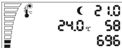
Esta última configuración se utiliza para cambiar entre el modo diario y el nocturno. Si el sensor de luz llega al nivel de cambio empieza cuenta regresiva en función de los segundos que ha introducido. Despues de pasar esta cuenta regresiva, el controlador pasará sólo del modo nocturno al modo diario y al revés, sin necesidad de interrumpir el sensor de luz.
