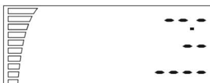
Dupa ce incepe initializarea senzorului, iar in cazul in care ecranul ramane in aceasta pozitie, inseamna ca exista o problema cu senzorul sau cu conexiunea acestuia. Verificati conexiunea de la senzor pana la dispozitiv. In cazul in care problema nu poate fi remediată, returnati dispozitivul pentru reparatie.
