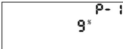
Pode configurar a velocidade que deve corresponder a 1 % da velocidade mínima. Carregue no botão para alterar os valores da tela ao girar o botão. Guarde o novo valor carregando no botão. Gire no sentido horário para ir às próximas configurações. Repita para todas as demais configurações.
