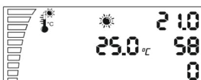
Se pressionar Down uma vez, aparecerá a configuração da temperatura diurna. Esta configuração ficará no ecrã por aproximadamente 10 segundos e após disso restabelece-se o estado primário do ecrã.
