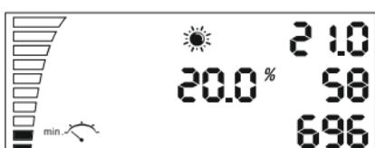
Voorbeeld: 10%rh bij 60% vochtigheid, de ventilator wordt ingeschakeld bij 60% vochtigheid en +10rh, bij 70%rh wordt maximale snelheid bereikt.
