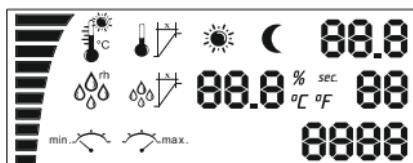
Indicatorul luminos cu LED începe să lumineze intermitent și ventilatorul intra în funcțiune. Aceasta durează deobicei câteva secunde. Initial pe ecran apar toti indicatorii și iluminatul fundal funcționează.
