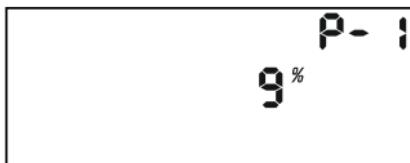
Teraz można dostosować prędkość, która musi odpowiadać 1% z minimalnej prędkości. Proszę nacisnąć przycisk, aby zmienić wartość wyświetlacza obracając przyciskiem. Proszę zapisać nową wartość, naciskając przycisk. Proszę przekręcić zgodnie z ruchem wskazówek zegara i przejść do kolejnych ustawień. Proszę powtórzyć dla wszystkich kolejnych ustawień.
