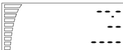
Därefter påbörjas sensorns initialisering. Om skärmen inte ändras, betyder det att det finns något problem med sensorn eller dess anslutning. Kontrollera kopplingen mellan sensorn och enheten. Om problemet inte går att lösa, returnera fläkten för reparation.
