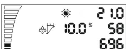
La regolazione dell'isteresi dell'umidità dell'aria durante il giorno è la stessa di quella dell'isteresi della temperatura dell'aria descritta qui sopra. Esempio: 10% rh e 60% d'umidità. Il ventilatore inizia a funzionare mentre c'è il 60% d'umidità e +10% rh e finché c'è il 70% di rh raggiunge la velocità massima.
