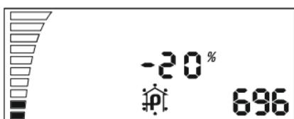
A pressão negativa diminui a velocidade do ventilador inspirador. Exemplo: com 20% o ventilador inspirador funciona 20% mais devagar do que o ventilador aspirador.
