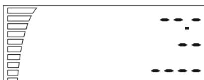
Em seguida, começa a inicialização do sensor e se o ecrã ficar nessa posição, isso significa que existe um problema com o sensor ou a sua conexão. Verifique a conexão entre o sensor e o dispositivo. Caso for impossível resolver o problema, deverá retornar o dispositivo para a reparação.
