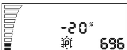
Ciśnienie ujemne zmniejsza prędkość wentylatora zasysającego. Przykład: przy 20%, wentylator zasysający pracuje 20% wolniej w porównaniu z wentylatorem odsysającym. Przy 0% oba wentylatory mają taką samą prędkość. Proszę zmienić wartość za pomocą przycisku SAVE/SET.
