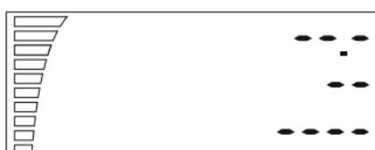
Potem zaczyna inicjalizację czujnika i w przypadku, że ekran zostaje w ten sposób, oznacza że jest problem z czujnikiem lub z jego wiązania. Proszę sprawdzić połaczenie czujnika z urządzeniem. W przypadku gdy problem nie może być usunięty, proszę wrócić urządzenia do naprawy.
