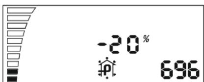
Presiunea negativa reduce viteza ventilatorului de absorbtie. De exemplu: la 20%, ventilatorul de absorbtie functioneaza cu 20% mai lent decat ventilatorul de aspiratie.
