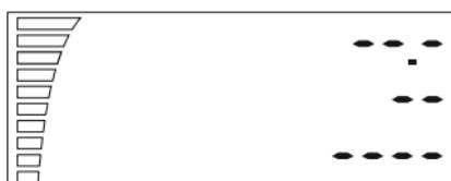
Daarna begint de initialisering van de sensor en in geval dat het scherm zo blijft staan, betekent het, dat er een probleem is met de sensor of met zijn aansluiting. De ventilator moet gerepareerd worden. Controleer de aansluiting van de sensor op het apparaat. Indien de storing niet kan worden verholpen, breng het apparaat terug voor reparatie.
