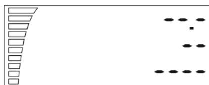
Etter dette starter sensoren opp og hvis skjermen forblir i denne tilstanden, betyr det at det er et problem med sensoren eller dens tilkoblingen. Sjekk tilkoblingen fra sensoren til apparatet. Skulle det ikke være mulig å fiksere problemet, returner apparatet for reparasjon.
