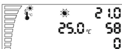
Se premete una sola volta sul tasto " In basso" appare la regolazione della temperatura. Questa regolazione apparirà sul display per 10 secondi e poi il display ritornerà al suo stato iniziale.
